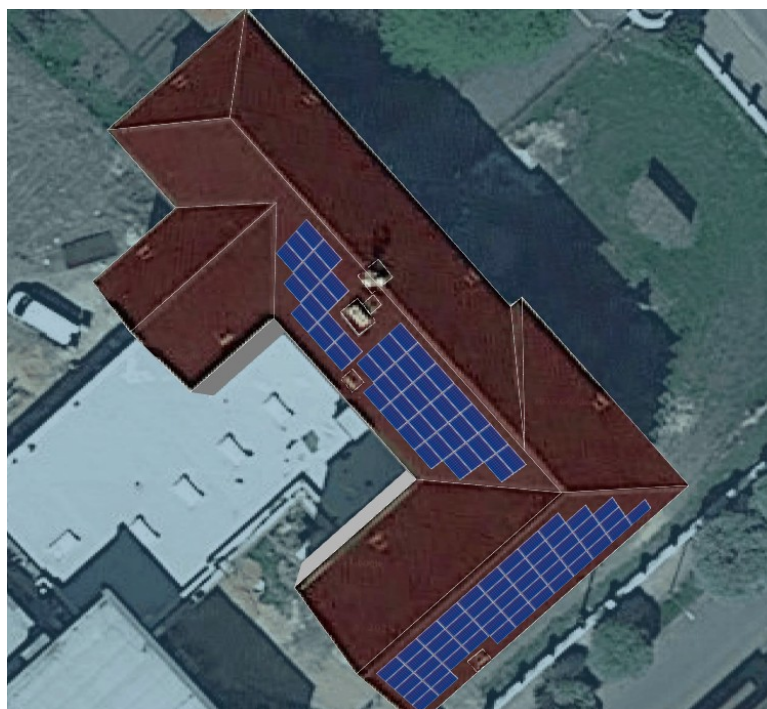
Obr. č. 30 - Umístění solárních panelů na budově ZŠ v ul. Tomáše Svobody
